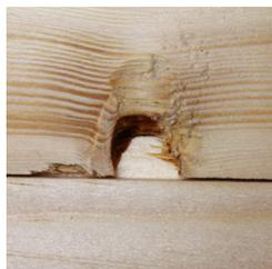
Nos planches à rainure et languette ont toujours un bon côté épais et un mauvais côté mince. Le grand nombre de branches sur des planches souligne le caractère naturel du bois et ne constitue pas une réduction de qualité. Ces branches peuvent également avoir des flaches sur le côté inférieur ou une languette ou rainure partiellement manquante.
