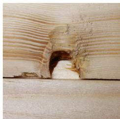
Le perline grezze da noi impiegate sono caratterizzate da un lato buono e spesso e da un lato più sottile e meno buono. L'elevato numero di nodi di rami sottolinea la naturalezza del legno e non è indice di scarsa qualità. Questo genere di tavole può essere dotato sul lato inferiore di uno smusso o essere dotati in parte di una scanalatura o di una linguetta.
