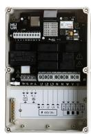
Bild zeigt die Steuerkonsole geöffnet
