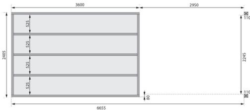
Fundamentplan ohne Boden (in mm)
