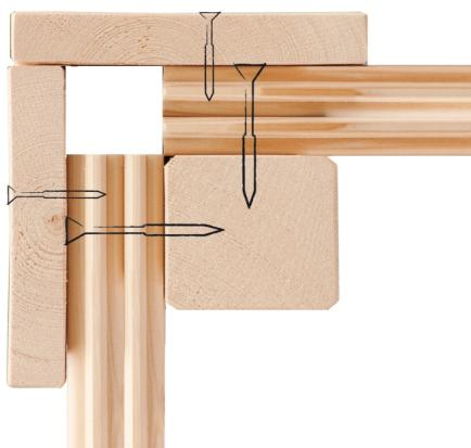
Doppelte Nut und Feder-Verbindung
